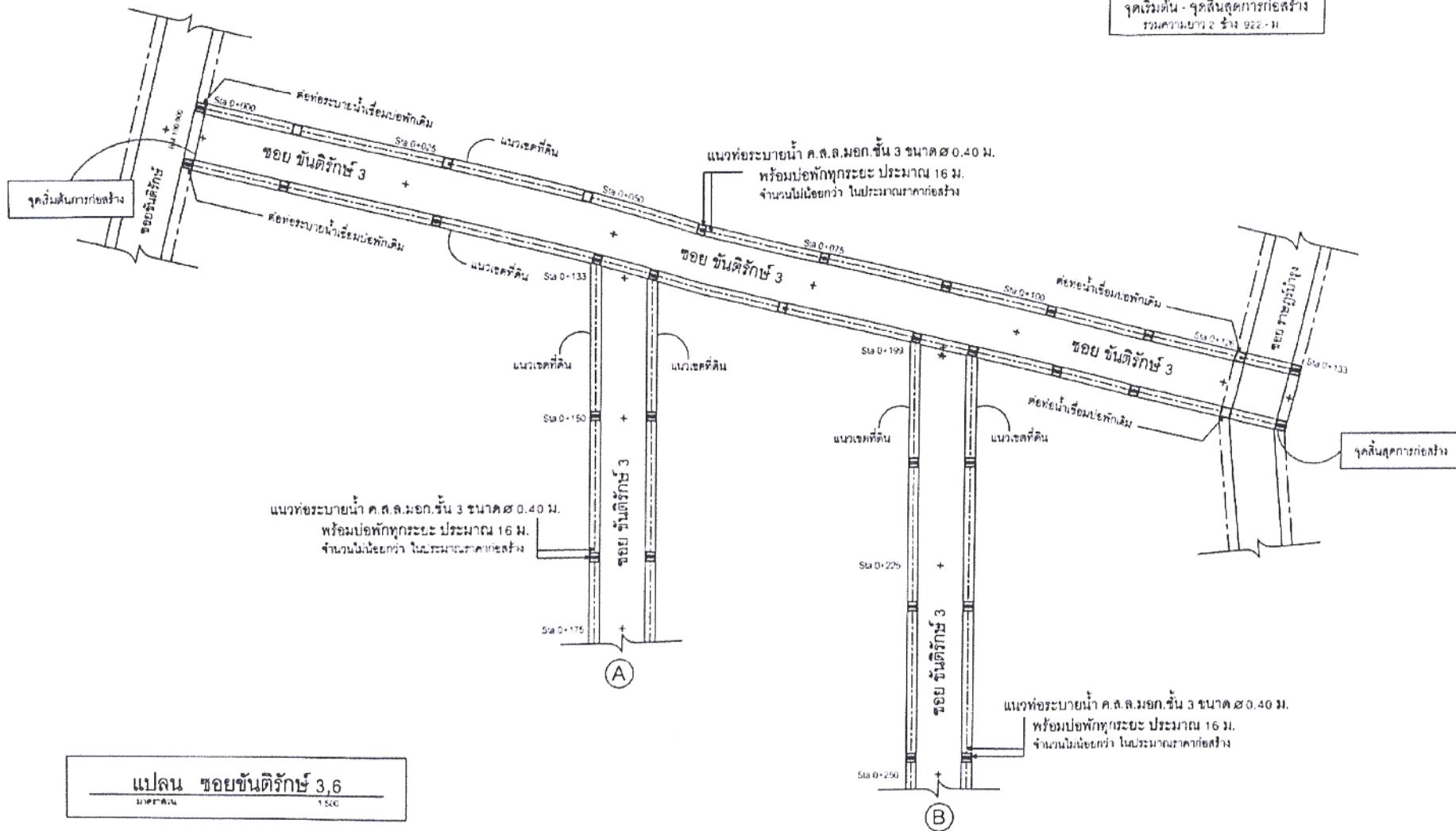
หมายเหตุ เส้นท่อ พีวีซี Ø 4" รั้งน้ำเสียเข้ม ลงปูอิฐห่อ จากอาคาร ทุกหลัง
