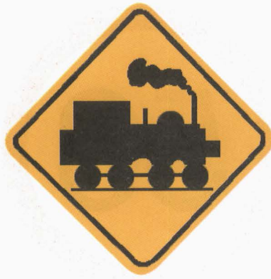
รูปที่ ๔๓ ป้ายเตือนทางข้ามทางรถไฟไม่มีเครื่องกั้น
